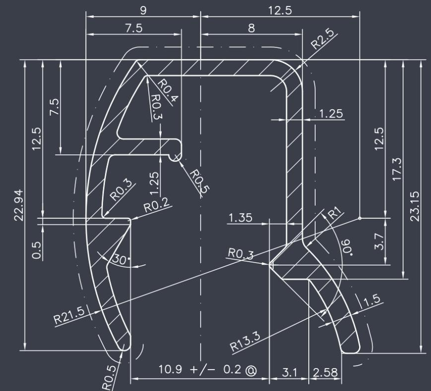
Précision dans les moindres détails : Coupe transversale du profil en aluminium pour le tableau blanc MAULpro
