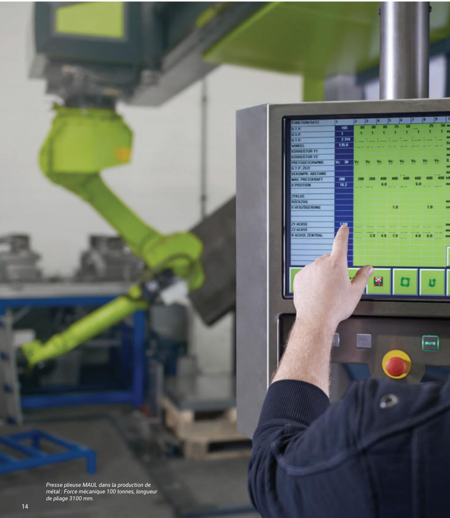
Presse plieuse MAUL dans la production de métal : Force mécanique 100 tonnes, longueur de pliage 3100 mm.
