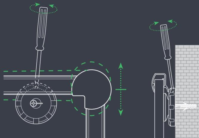
Montage facile : Réajustez facilement le tableau MAULpro jusqu'à 6 mm après montage avec l'élément excentrique breveté MAUL.
