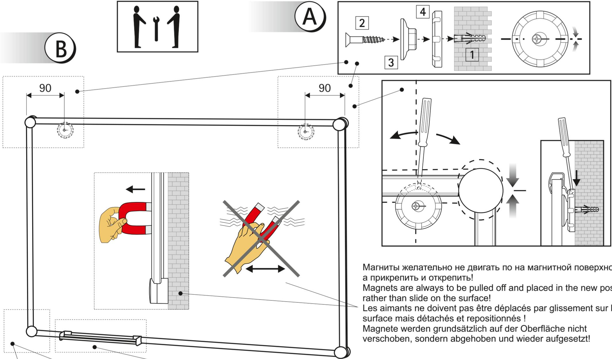
Магниты желательно не двигать по на магнитной поверхности, а прикрепить и открепить!
