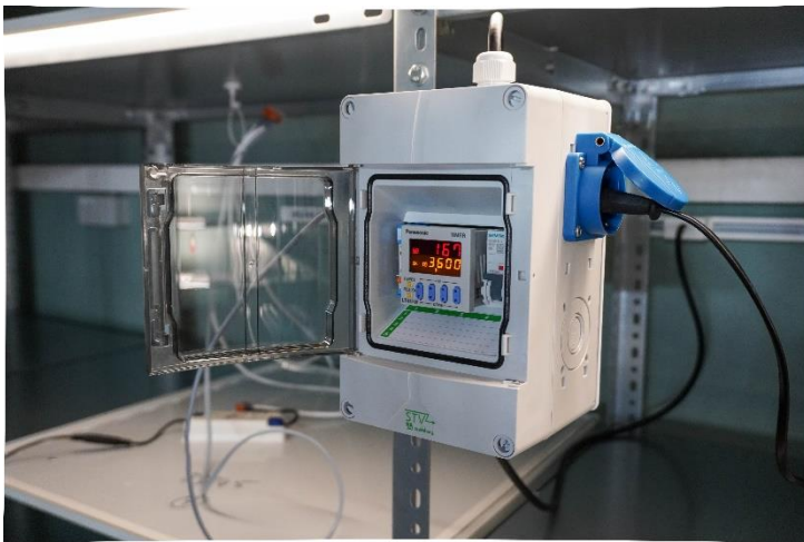
Bildunterschrift: Zeitschaltuhr für die Umsetzung der Zyklisierungsintervalle im Dauertest
