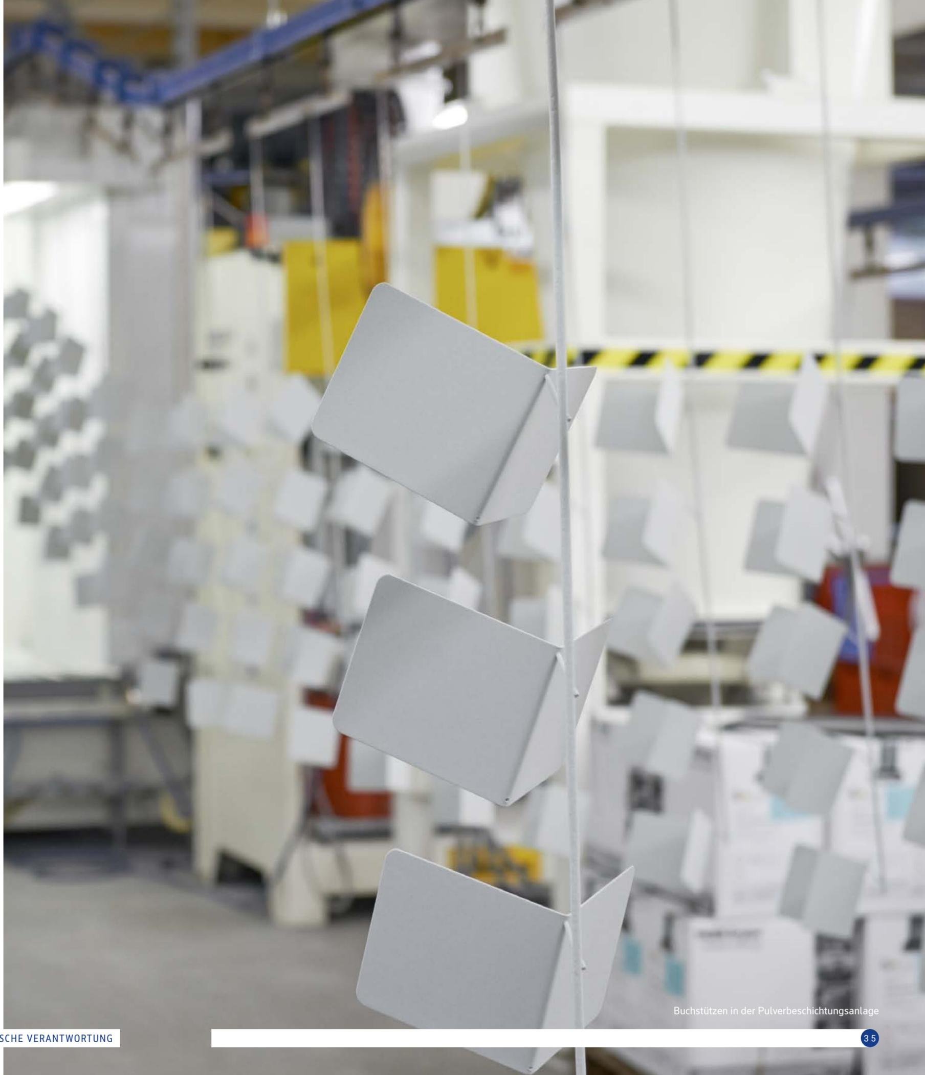
Buchstützen in der Pulverbeschichtungsanlage
