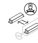
Předádřný přístroj vyměnitelný kvalifikovaným elektrikářem
