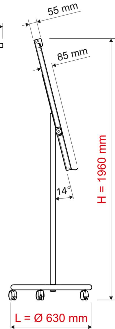
stufenlos höhenverstellbar von 1720 mm bis 1960 mm
