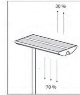
Éclairage du luminaire: Indirect : 1.250 lux à 85 cm de distance, 800 lux à 110 cm de distance - direct : 520 lux à 85 cm de distance
