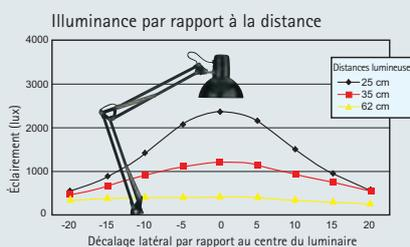
Le graphique vous permet de déterminer la quantité de lumière incidente sur votre bureau à certaines distances. L'axe vertical indique l'éclairage (Lux) à des distances de 25 (noir), 35 (rouge) et 62 cm (jaune) entre la tête du luminaire et le bureau. L'éclairage maximal pour la distance correspondante se trouve à une distance de 0 cm sur l'axe horizontal (verticalement sous la tête du luminaire) et diminue avec le décalage latéral.
