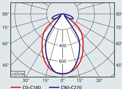
La courbe de répartition photométrique (ou courbe de répartition de l'intensité lumineuse) représente la distribution de lumière dans l'espace en partant de la tête de luminaire. Le concepteur lumière peut y déterminer l'intensité lumineuse attendue en fonction de l'angle dans deux niveaux spatiaux exemplaires. En d'autres termes :
