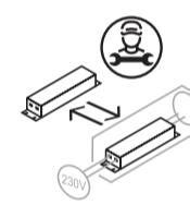
Appareil de commande remplaçable par un électricien
