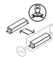
Możliwość wymiany urządzenia sterującego przez elektryka
