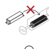
Bez możliwości wymiany urządzenia sterującego
