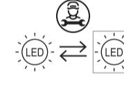
Fonte luminosa LED sostituibile da parte di un elettricista qualificato
