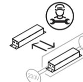
Устройство управления допускает замену квалифицированным электриком
