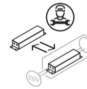
Předřadný přístroj vyměnitelný kvalifikovaným elektrikářem
