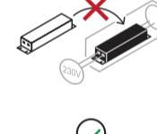
Předřadný přístroj není vyměnitelný
