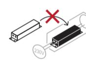
Appareil de commande non remplaçable
